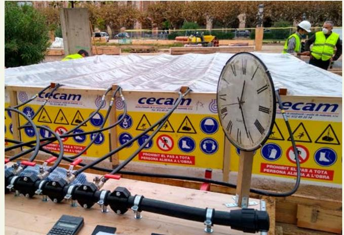
Pruebas de infiltración para pavimento granular drenante sobre SUDS. Parque de la Ciudadela, Barcelona
