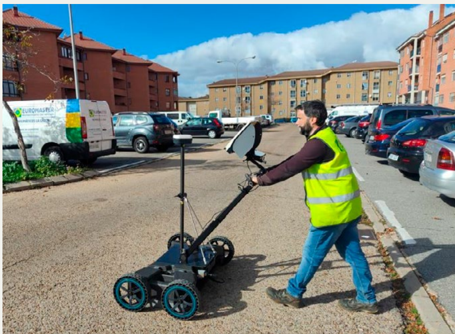
Uso de georradar para la toma de datos
